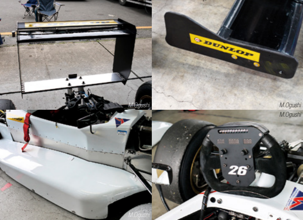
内村さんのオリジナルマシンは一見すると、他と大差ないように見える。しかし、フロントウイングの翼端板はまな板できているというから驚きだ(右上)。さらにステアリングのディスプレイも手作り(右下)。これらの作る過程におけるアイデアがたくさん詰まっている。モノづくりが色濃く残るJAF F4ならではの見えるだろう。
